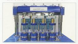
一度に 4 つの供試体を載荷しますので、1 台で装置 4 台分のランニングコストをカバーでき、また、試験時間も1/4 に短縮できます。
