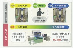
飽和作業を除く全ての工程がコンピュータによる自動制御で 行え、供試体をセット・飽和後は無人で試験可能です。夜間試験 が可能となり、業務効率を大幅に向上させます。
