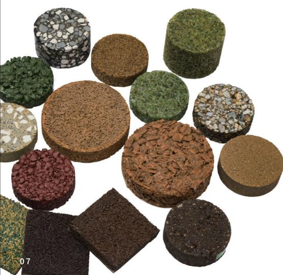
我们能够满足各种需求，从利用各种再生石材的沥青合成材料到采用天然石材的彩色沥青合成材料。为了实现循环利用，再生骨料由我们集团内的再生企业进行产品化，并用于沥青合成材料的生产。我们与自己的试验室合作，无论天气条件或原材料如何，都能实现高水平的品质管理。
